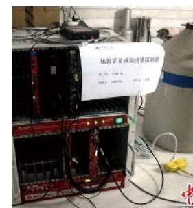
「中國錦屏地下實驗室」中用於暗物質探測的超低能量閾高純鉻探測器。楊傑／攝
