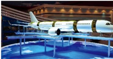
中國大陸自主研製C919中程客機，中央翼用碳纖維複合材料，後機身部位為全複合材料和蒙皮整體固化結構。（網路圖片）
