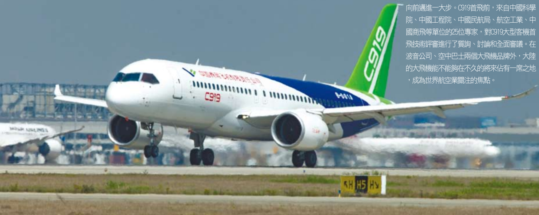
C919在上海浦東機場進行高滑抬前輪試驗。（新華社 王晉傑攝）
