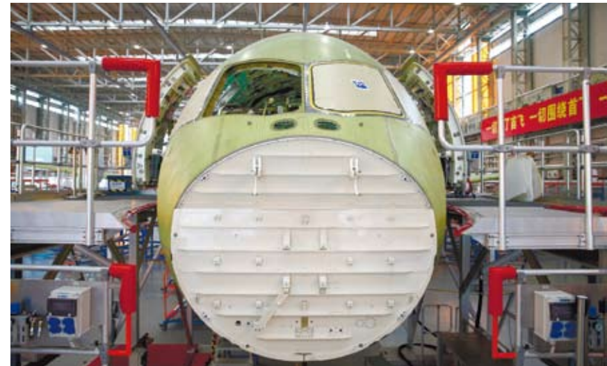
C919大型客機102架機在中國商飛公司上海飛機製造有限公司總裝車間內進行系統裝配。（新華社 丁汀攝）
