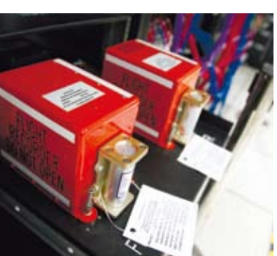
這是航電試驗室內在進行系統驗證和測試的C919的飛機「黑匣子」。（新華社 裴鑫攝）
